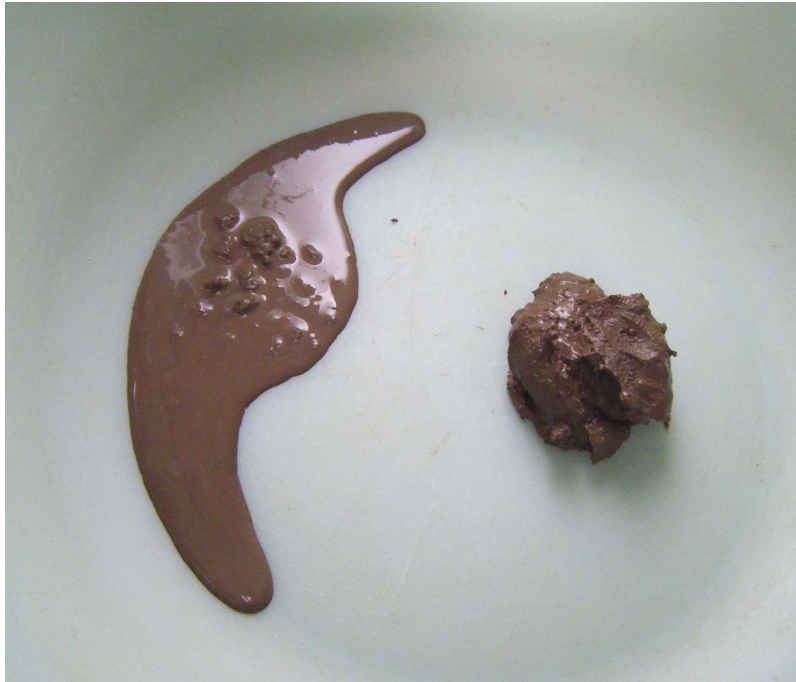
写真左 : NJ パワーN 添加後 写真右 : 原土 (香港地下鉄掘削土)
